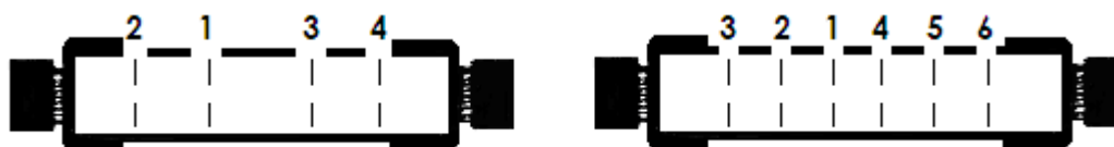
Figura 6 - Ordem de cravação das uniões de pré-isoladas
